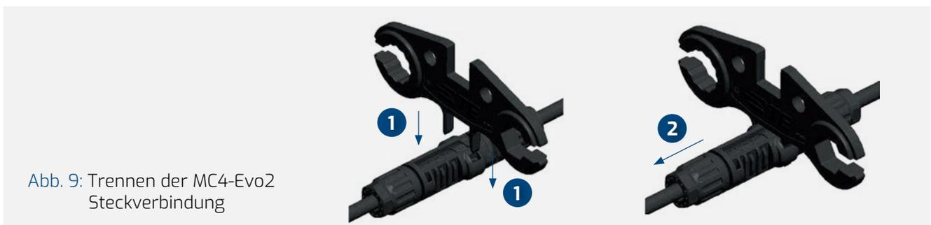
Abb. 9: Trennen der MC4-Evo2 Steckverbindung
